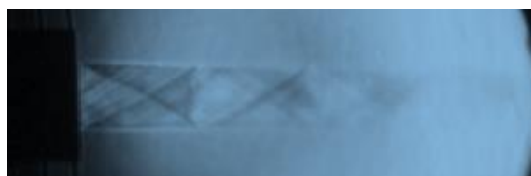
(d) Nozzle controlled with 3.5 mm strut
